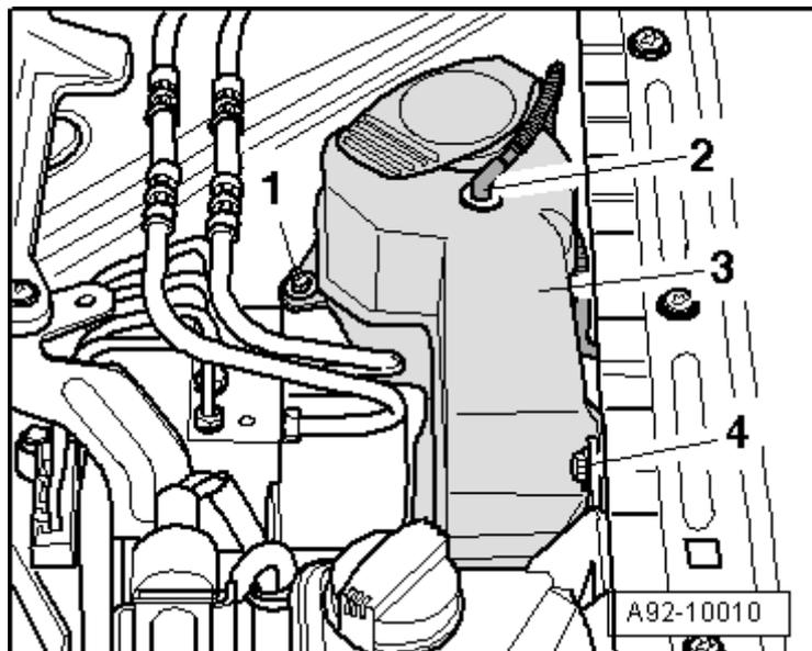
Desmontar el elemento inferior del depósito
